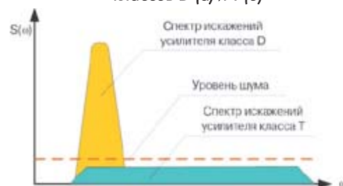
Рис. 2. Распределение энергии в спектре искажений на выходе усилителей классов D и Т
